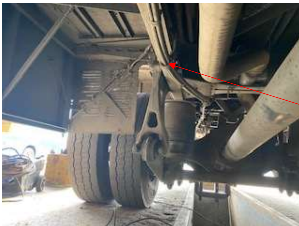
Foto 2 – Vista dos feixes de molas que eram substituídos pelo Autor.
